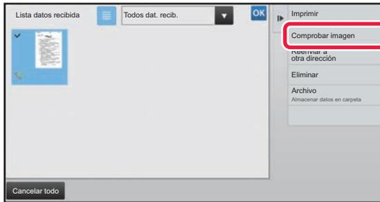
**Pulse la tecla correspondiente a los datos recibidos que desee comprobar y pulse [Comprobar imagen] en el panel de acciones.**
