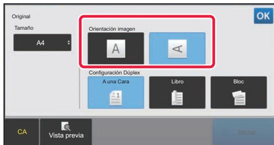
**Pulse la tecla [Orientación de la imagen] que corresponda a la orientación del original colocado.**
