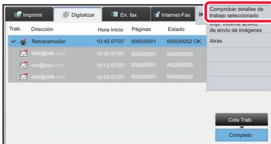
Después de pulsar la tecla de la retransmisión completada, pulse [Comprobar detalles de trabajo seleccionado] en el panel de acciones.
