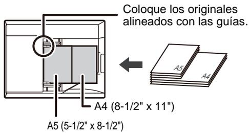
**Coloque el original en la bandeja del alimentador de documentos automático.**
