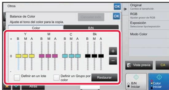
Pulse la tecla **- +** o arrastre el control deslizante para ajustar el balance de color.
