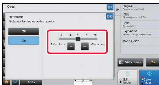
Pulse la tecla **- +** o arrastre el control deslizante para ajustar la intensidad.
