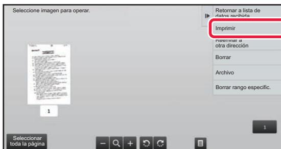
**Pulse la imagen que desee imprimir y pulse [Imprimir] en el panel de acciones.**
