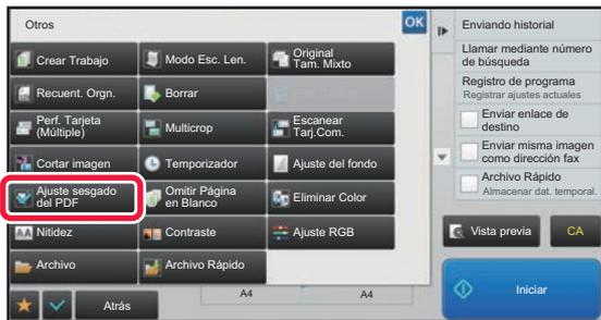
**Pulse la tecla [Otros] y, a continuación, pulse la tecla [Ajuste de sesgado del PDF].**
