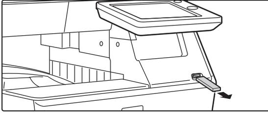
**Lea el mensaje [Se ha completado el envío de datos.] y retire el dispositivo de memoria USB de la máquina.**
