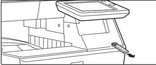
Retire el dispositivo de memoria USB de la máquina.
