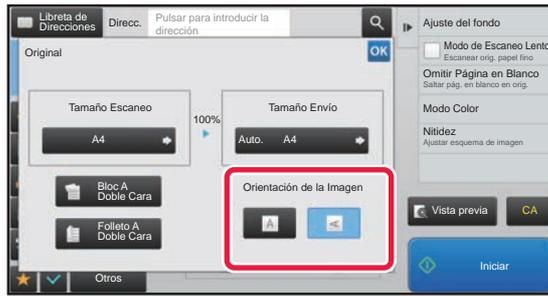
**Pulse la tecla [Orientación de la Imagen] que corresponda a la orientación de la imagen original.**
