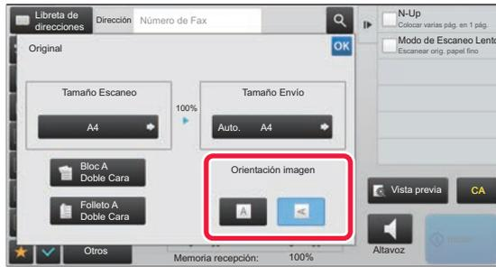
**Pulse la tecla [Orientación imagen] que corresponda a la orientación del original colocado.**
