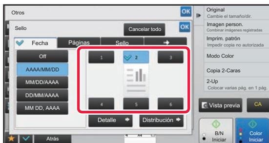
**Pulse una tecla que corresponda a la posición de impresión deseada.**
