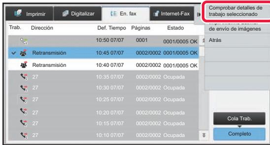
Después de pulsar la tecla de la retransmisión completada, pulse [Comprobar detalles de trabajo seleccionado] en el panel de acciones.
