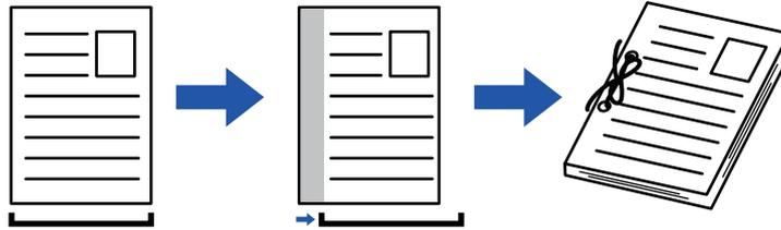
Desplazando la imagen, la parte de la imagen que queda fuera del área de impresión no se imprimirá.
