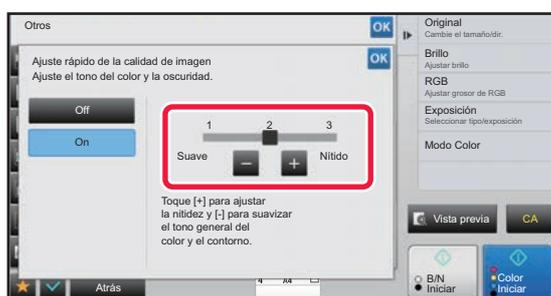
Pulse **-** **+** o arrastre el control deslizante para ajustar la calidad de imagen.
