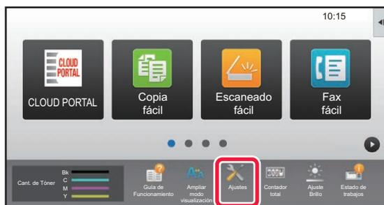
**Asegúrese de que el indicador de notificación de datos parpadee y pulse la tecla [Ajustes] en la pantalla de inicio.**
