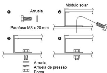
Figura 5. Os elementos do parafuso e porca
