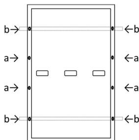
Fig. A3: Localização dos furos dos parafusos
