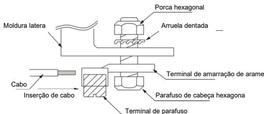
**Figura 3: Exemplo de conexão de terra aceitável**
