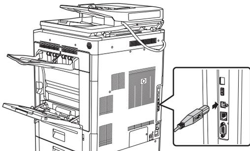
(3) Conecte el otro extremo del cable al conector USB (tipo A) del ordenador.
