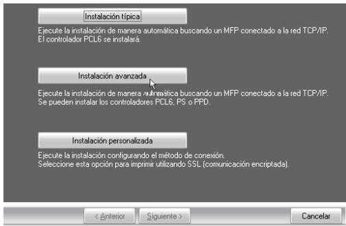
✎ Cuando haya elegido [Instalación personalizada], puede cambiar cualquiera de los elementos a continuación. Cuando haya seleccionado [Instalación típica], la instalación se producirá según lo indicado a continuación.
