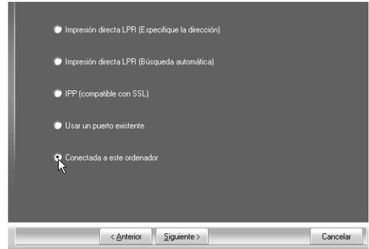
**4 Cuando aparece la ventana de selección de puerto, seleccione el puerto que utiliza el controlador de la impresora PCL6 o SACL-c (USB001, etc.) y pulse el botón [Siguiendo].**
