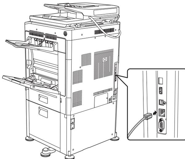
Después de conectar la máquina a una red, asegúrese de configurar la dirección IP y otros ajustes de la red antes de instalar el software. (El ajuste predeterminado de fábrica para la dirección IP es recibir la dirección IP automáticamente cuando la máquina se utiliza en un entorno DHCP.)
