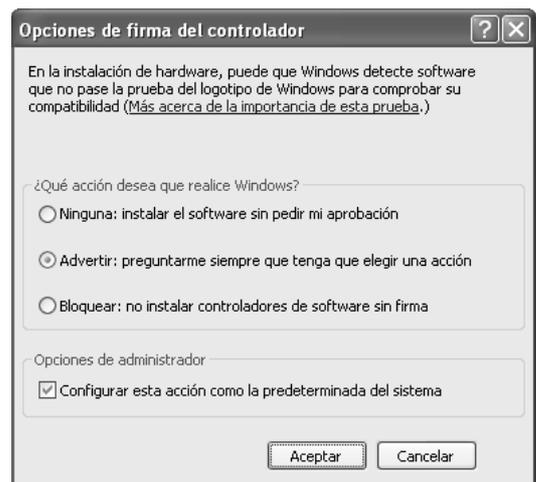
Si [Bloque] está seleccionado, no se puede instalar el controlador de la impresora. Seleccione [Advertir] e instale de nuevo el controlador de la impresora-
